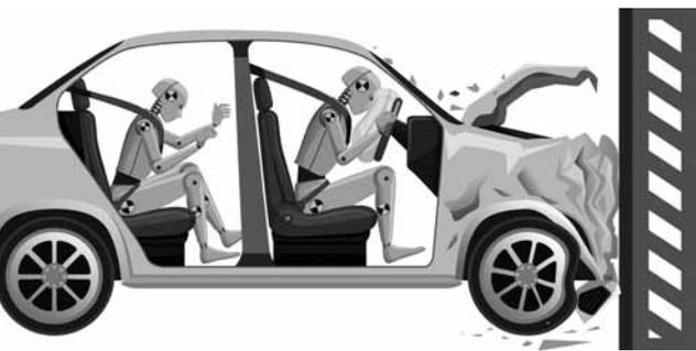
durch den Gurt bei Tests erkannt wurde und auch klar war, dass der Schutz trotz der freigegebenen Millimeter ausreicht. Die Energie eines Aufpralls wurde bis zum Zeitpunkt der nachlassenden Gurt-
